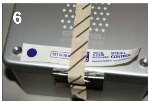
6. De teststrip verkleurt paars en de indicatietape vertoont zwarte lijnen, als teken dat de juiste sterilisatietemperatuur van 121°C bereikt is.
