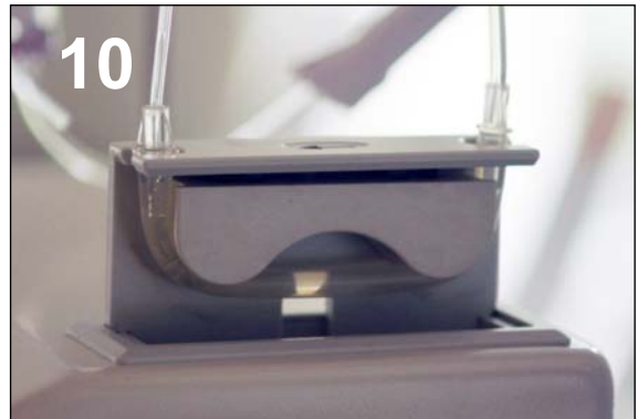
10. Infusieslang: het deel met de verdikking bevestigen in de watergeleider op de machine. Let op de pijl (op de watergeleider). Slang van achteren naar voren bevestigen.
