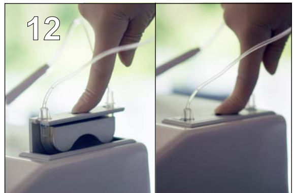
12. Druk de watergeleider naar beneden, zodat deze in de machine verdwijnt. Zodra voetpedaal en micromotor aangesloten zijn, is machine gereed voor gebruik.
