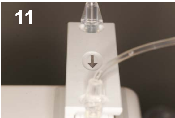
11. Slang in de watergeleider moet van achteren naar voren bevestigd worden.
